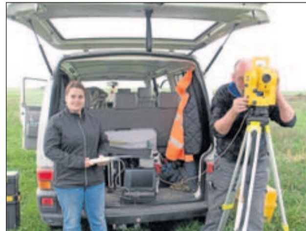
Mit dem elektronischen Tachymeter misst Martin Oppermann im Infrarotverfahren Winkel und Strecken. Auf diese Weise entsteht ein Plan, aus dem zum Beispiel hervorgeht, wie ein Haus in der Landschaft stand. Den Computer im Hintergrund bedient Katharina Kupke.
