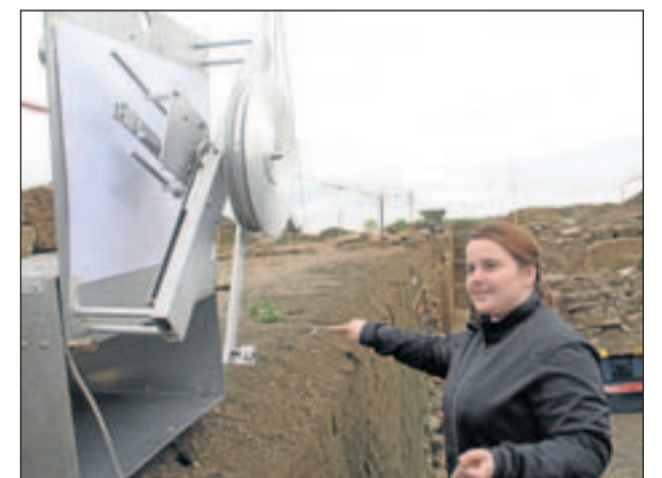
Katharina Kupke bedient den Pantografen. Mit dem Stift in der rechten Hand zeichnet sie das Profil des Bodens nach. Mit dem Blasebalg in der linken Hand setzt sie den Stift des Pantografen auf das Papier. Hier überträgt sie das Profil des Bodens.
